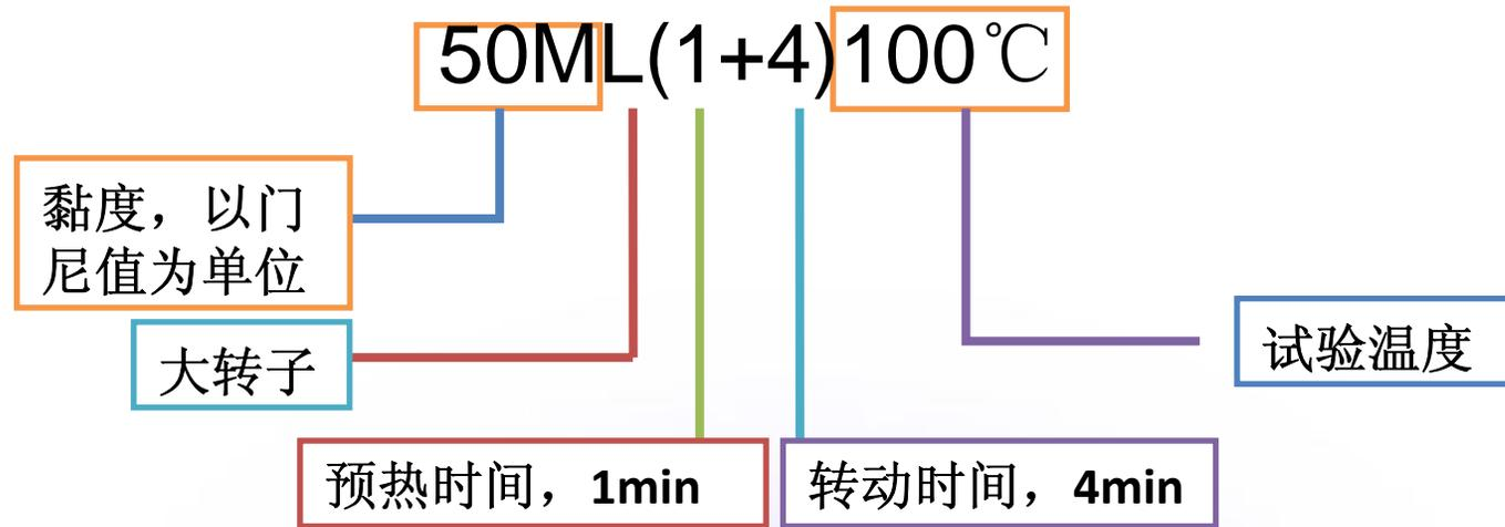
(2) 测定值精确到0.5个门尼值, 试验结果取整数位。
